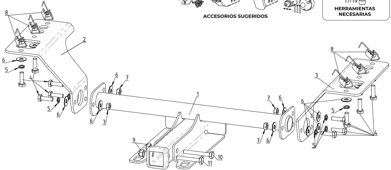
⚠ Atención: no ajustar totalmente las placas hasta colocar el travesaño.
